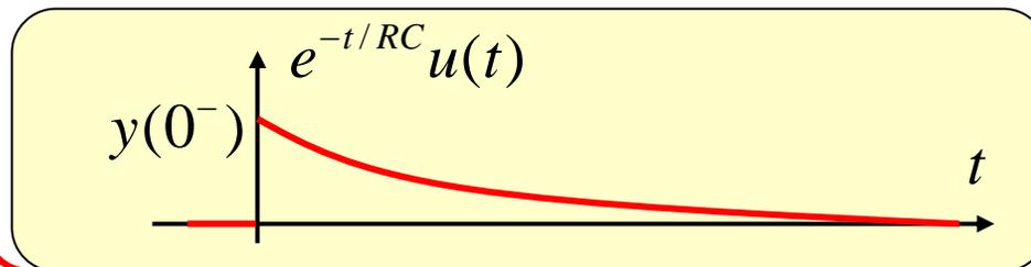
So... the part of the sol'n due to the IC (zero-input sol'n) decays down from the IC voltage
